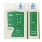
断線のチェックはもちろん、内部結線順序も確認できます。圧着工具、コネクタを使って LAN ケーブルまで自作してしまうようなヘビーユーザーさんにもオススメです!
