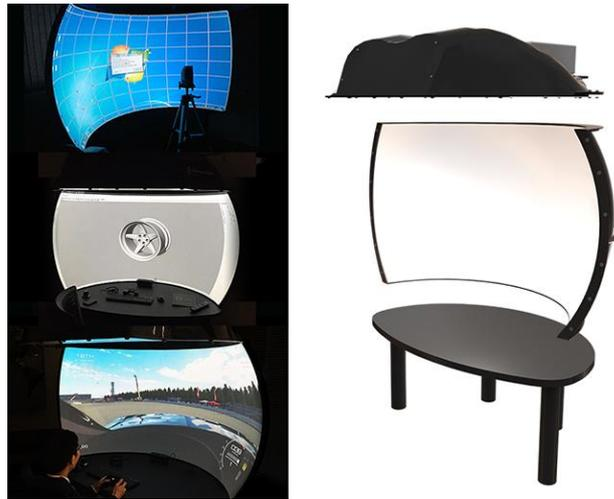
プロジェクターからの映像を独自の形状に湾曲させたスクリーンへ投影させることで没入感の高い視覚ソリューションを実現します。広がりのある映像、ゲームなどにも応用できます。
