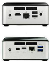
USB2.0 および USB3.0 端子、有線 LAN 端子を搭載しています。HDMI 端子も標準で搭載されているので、液晶テレビや大型ディスプレイに接続すれば、パソコンに保存してある画像・動画を大画面で共有できます。さらに、天板が簡単に開くようになっており、無線 LAN モジュールをはじめ、各種周辺機器を追加することができます。
