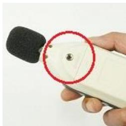
本体裏面にカメラ三脚用のネジ穴があるので、カメラ用三脚（別売）に固定して使うことができます。手の動きなどによる余計な騒音が加わる心配もなく、表示画面を撮影して記録するなどにも役立ちます。
