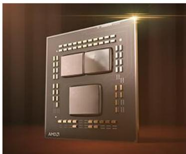
Zen 3 アーキテクチャーでは、Zen 2 世代同様 7nm プロセスで製造されており、最大動作クロックが増加、IPC の向上、新たなコア構成となり、キャッシュが改善など多くの点が改良されました。大きな変更点としてこれまでは、4 つの CPU コアを 1 つのクラスタ単位 (CCX : Core Complex) としていたのに対し、Zen 3 アーキテクチャーでは、8 つの CPU コアを 1 つのクラスタへと変更しました。この CCX の変更によりコア間のレイテンシが改善され、L3 キャッシュメモリが 8 コアすべてで共有され実質的な容量が倍増、アクセスが高速化しました。これらの様々な CPU コアの改良によって、IPC が最大で 19% 向上し、電力効率も向上しました。
