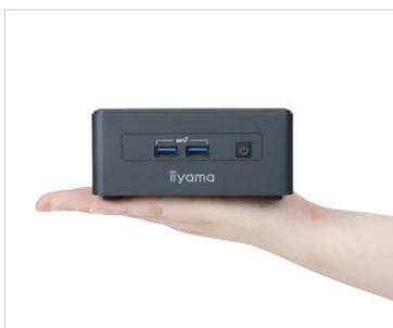
インテル® NUC 11 Pro は小さな筐体（117 x 112 x 54 mm）のため、設置する場所を選びません。小型ながらインテル® vPro® に対応しているためインテル® AMT の機能が利用でき、OS や使用するアプリケーションの更新作業などソフトウェアレベルでの遠隔管理から、電源の操作や BIOS の設定などハードウェアレベルの管理も可能です。また、インテル® ハードウェア・シールドにより効率的にセキュリティ強化がされます。
