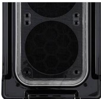
アクリルスタンドは防塵フィルターと一体化されており、埃の侵入を防ぎながら外気を取り込む事で冷却効率を高めています。アクリルスタンド部分は着脱が可能ですので、フィルターのメンテナンスも容易に行えます。
