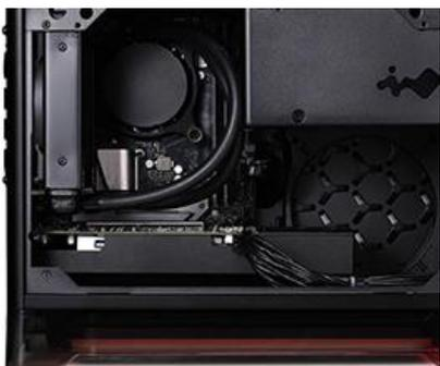
筐体サイズは幅 224mm×奥行 357mm×高さ 273mm とコンパクトサイズですが、拡張性に優れ、2.5 インチストレージや 320mm までのフルサイズグラフィックスカードの増設など用途に合わせた柔軟な拡張が可能です。ケース背面には 12cm ファンを標準で搭載、水冷クーラーも取り付け可能です。
