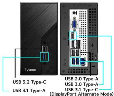
USB3.2 Type-C ポート x1、USB3.1 Type-C ポート(DisplayPort Alternate Mode)x1、USB3.1 Type-A ポート x1、USB3.0 Type-A ポート x2、USB2.0 Type-A ポート x2 を搭載しています。マウスやキーボードだけでなく、様々な USB 機器を接続することが可能です。
