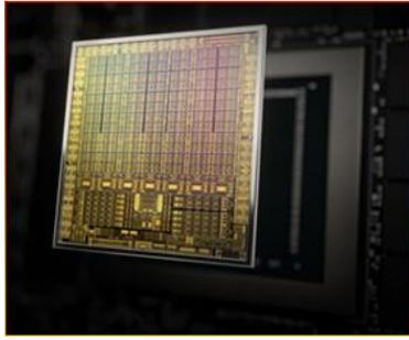
GeForce RTX™ 30 シリーズは、2 倍の処理能力を持つ第 2 世代 RT コア、最大で 2 倍の処理能力を持つ第 3 世代 Tensor コア、2 倍の浮動小数点演算（FP32）処理能力を持つ新しい SM（Streaming Multiprocessor）からなる、進化した第 2 世代 RTX アーキテクチャを採用しました。
